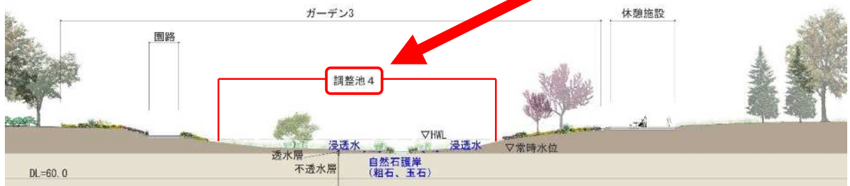
図 7.1-4 調整池 4 の位置及び模式断面図
